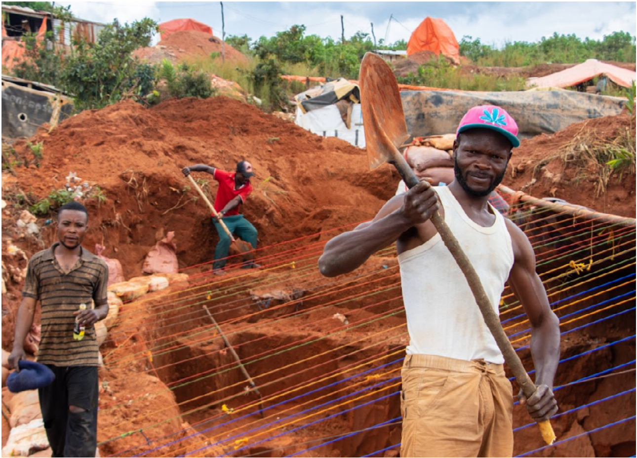
Des creuseurs placent une bâche pour protéger les entrées des tunnels contre les inondations. Entre 150 000 et 250 000 personnes travaillent dans le secteur artisanal du cobalt en RDC, contribuant à 5-6% de la production de cobalt du pays. Ce chiffre est important, car la RDC représentait 73,9 % de la production mondiale de cobalt en 2024 (USGS).
